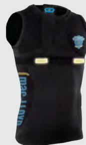
Figure 7—T-shirt connecté permettant l'enregistrement de la fréquence cardiaque et la synchronisation de ces données aux enregistrements GPS/GNSS. Source : Mac-Lloyd sport.
