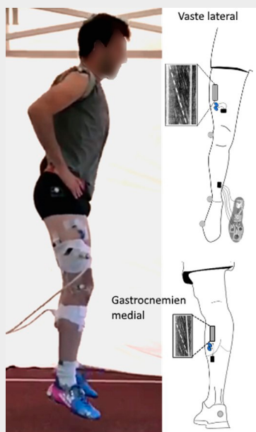
Figure 1 - Vue latérale d'un athlète lors de la réception d'un saut en contrebas à deux jambes (à gauche) avec représentation schématique des outils utilisés (échographie ultra-rapide, capteurs de pression, électromyographie de surface et analyse cinématique) (à droite).
